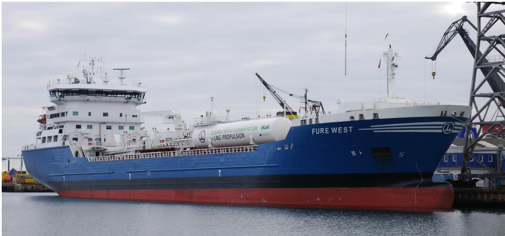
Fure West, kemikalietanker. Furetank Rederi AB, byggd 2006 och senare konverterad till LNG 2015.
