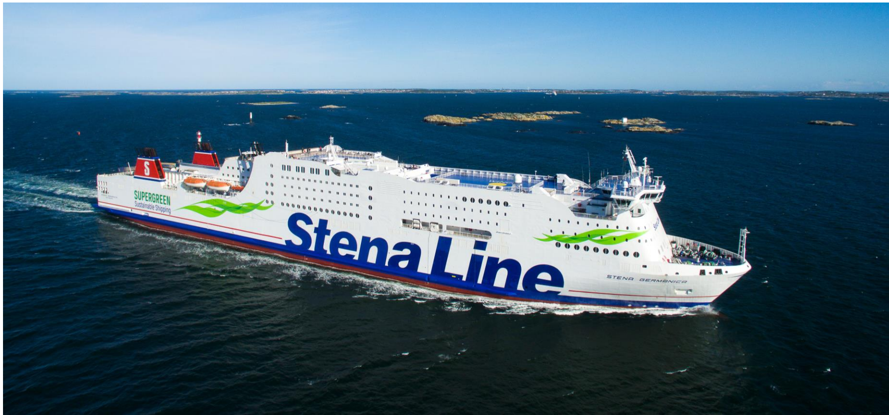
Stena Germanica, passagerarfärja. Konverterad till metanoldrift. Byggd 2001.
