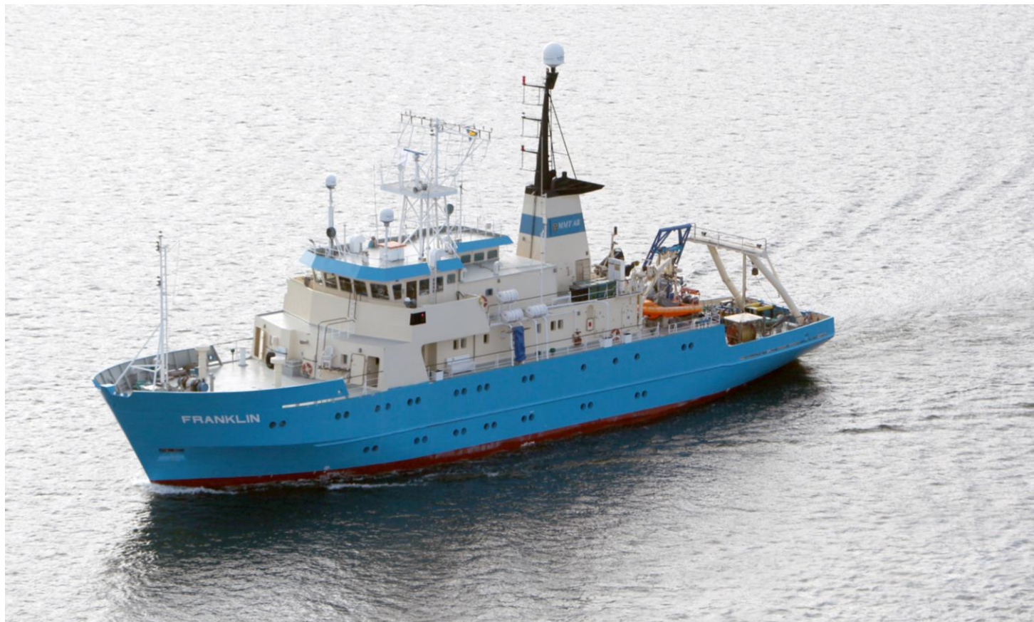
Franklin, DP1 Survey & ROV Vessel, MMT AB
