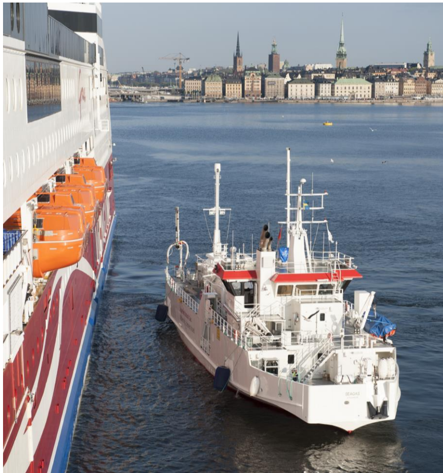
Bunkersfartyget Seagas vid M/S Viking Grace för att bunkra LNG. Byggd 1974.
