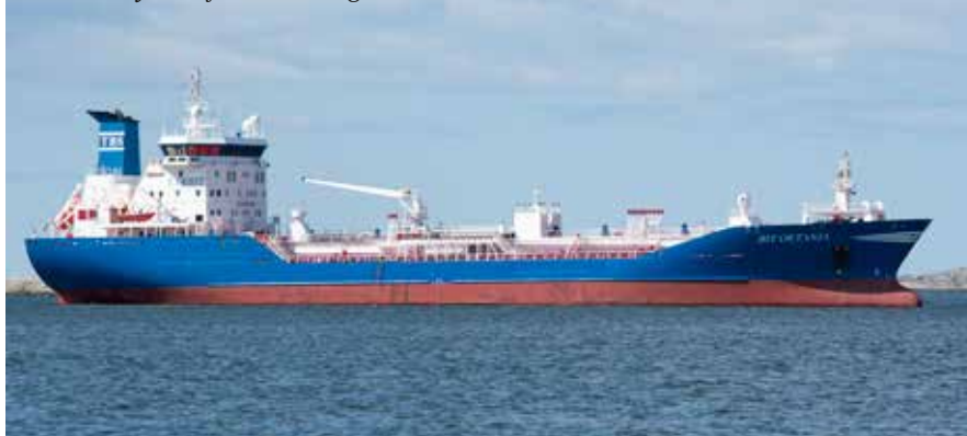
Bit Oktania hyrs in av Preem och är utrustad med katalysator för reducering av NOx.
